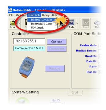
步驟 11: 在 Modbus TCP 配置區域中,輸入 tGW-715 的 IP 位址 and TCP Port , 在單擊 "Connect" 按鈕來連線至 tGW-715。
