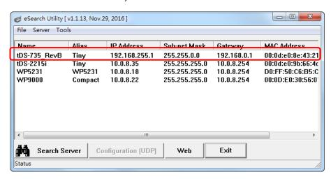
步骤 3 修改模块基本网络设定 (如: IP、Mask、Gateway 地址),再按 "OK" 按钮来储存新的设定值。
