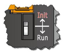
**步骤 2** 执行 VxComm Utility 或 eSearch Utility 来搜寻模块。此时搜寻到的模块已回复至原厂默认值。(如: 预设 IP Address 192.168.255.1)
