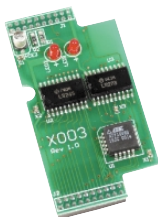
7188XC自测试板X003 (64mm x 32mm); 0.2W
